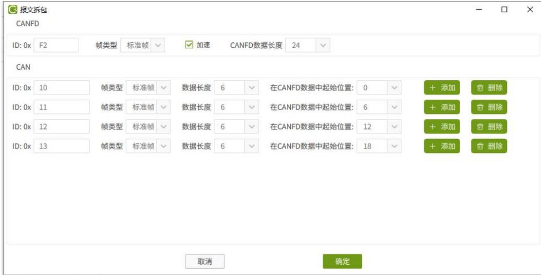
图 6.38 24 字节 CANFD 拆分为 4 个 6 字节 CAN 设置
