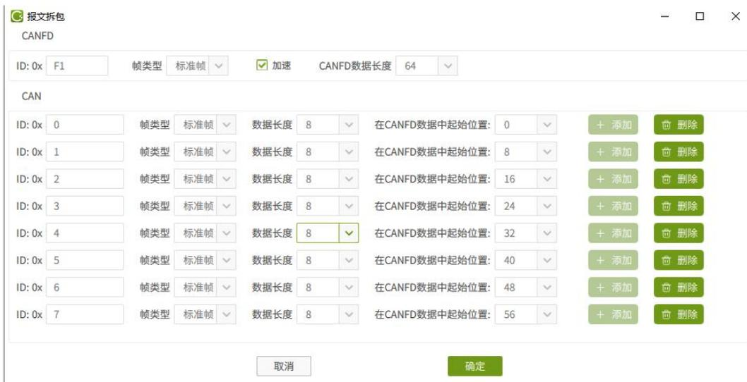
图 6.36 64 字节 CANFD 拆分 8 个 8 字节 CAN 设置
