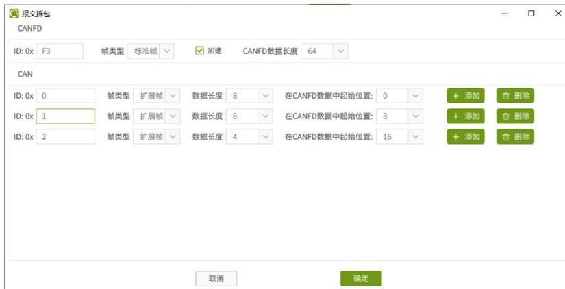
图 6.40 64 字节 CANFD 拆分为 2 个 8 字节 CAN 设置
