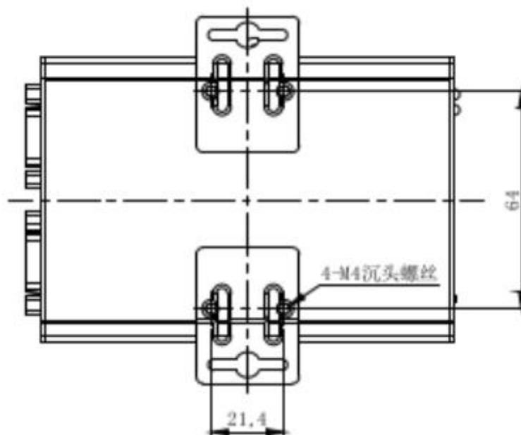
图 3.2 CANFDBridge+安装图
