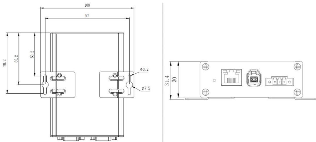
图 3.2 主机尺寸图二
