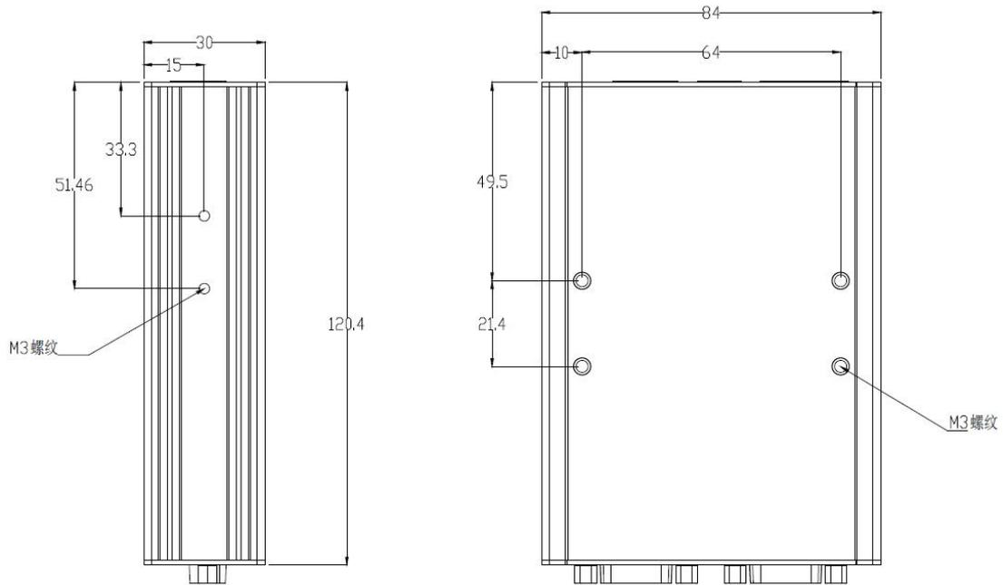
图 3.1 主机尺寸图一
