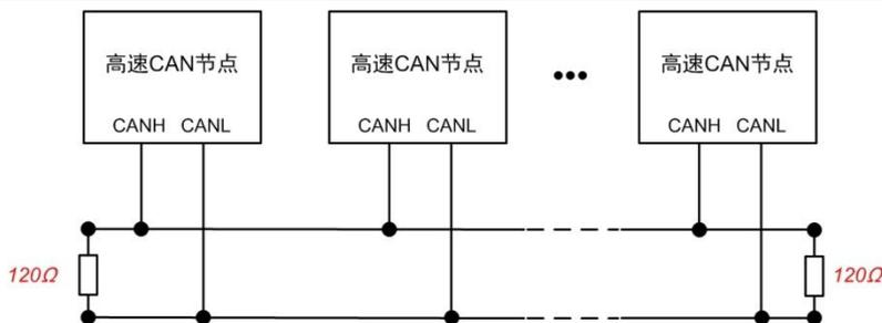
图 4.2 高速 CAN 典型网络连接示意图
