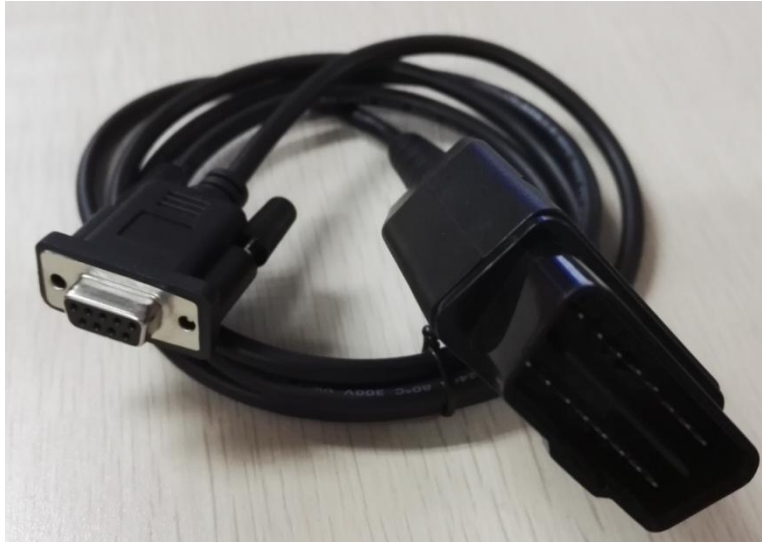
图 B.1.1DB9-OBD 外观示意图
