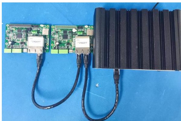
图 14 主从站设备实物连接图
