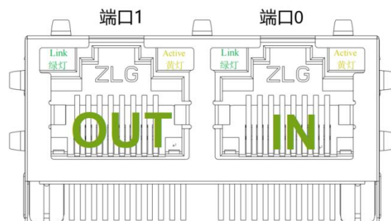
图 13 DPort-ECT 输入输出端口
